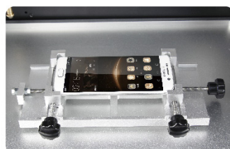
夹具固定终端四角, 夹紧之后终端 无法任何方位的移动
