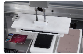
移动Z轴靠近夹具上的终端以测试NFC功能
