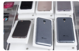
NFC夹具可进行翻转以测试不同接触角度的NFC功能
